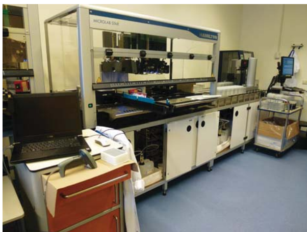
De grote robot in het DNA lab die het DNA isoleert uit bloed.
